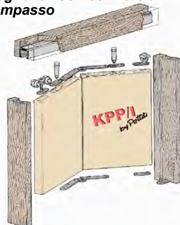
Esempio di scorrevoli per porte pieghevoli a battente con cerniere a compasso
